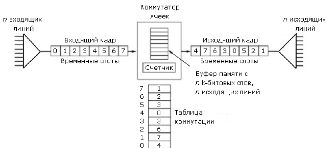
Рисунок 2-54. Коммутатор с разделением времени
