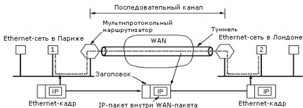
Рисунок 5-37. Транспортировка пакета методом туннелирования
